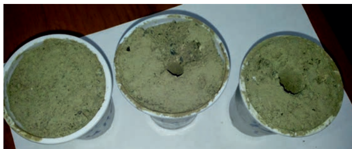
Рисунок 5.18 - Брикеты без воздушного канала и с каналом в виде стержня
