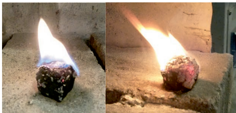
Рисунок 5.11- Горение брикетов из Ой -Карагайских углей с вяжущим полиэтилентерефталатом
