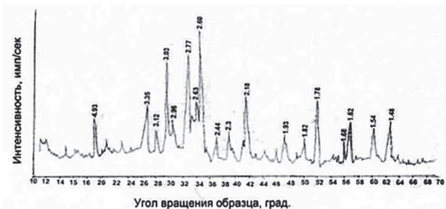
Рисунок 4.13 – Рентгенограмма цементного камня состава из цемента (70%) и золошлаков (30%), затвердевшего в течение трех суток в нормальных условиях
