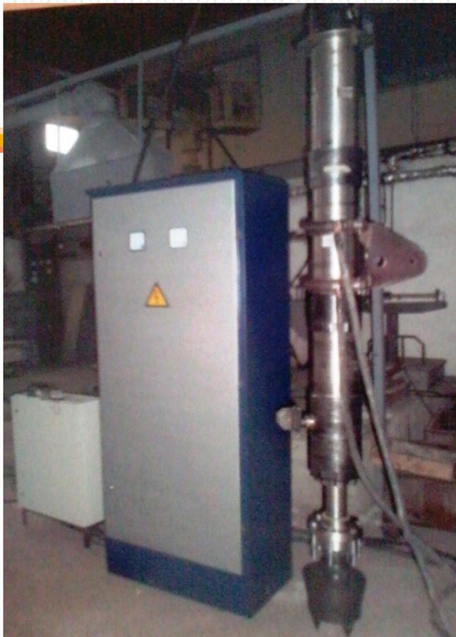
1. Разработано и создано в металле гидроимпульсное устройство для проходки газификационных каналов большого сечения на подготовке крутопадающих угольных пластов для отработки новыми методами подземной газификации.
