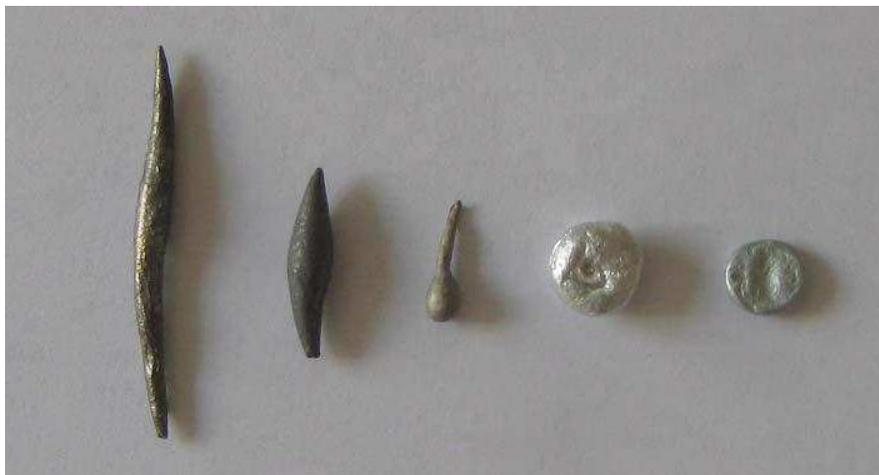
Рисунок 1 – Внешний вид металлических гранул: а – висмут, б – свинец, в – кадмий, г – алюминий, д – цинк.
