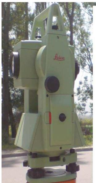
Leica TC 407 тахеометрі
